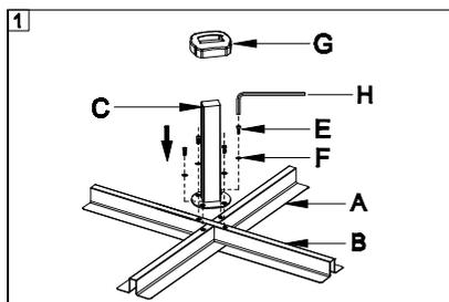
**PASO 1.** Posicionar la base y conectarla con la parte C. Encastre la base con la parte C utilizando los tornillos (E-F) y con ayuda de la llave allen(H).
