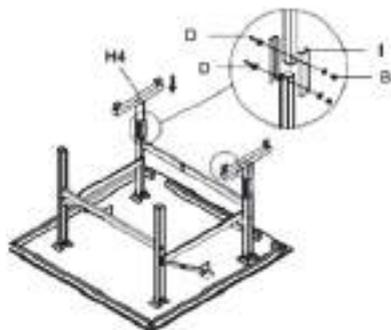
2. Una vez armadas todas las patas, debe colocar sobre una superficie firme la tabla de la mesa, la cara superior del lado del suelo, en la contracara se deberá instalar las patas.
