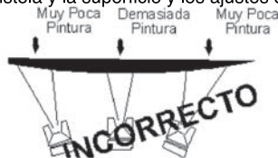
Fig. 4 Forma incorrecta de rociar
