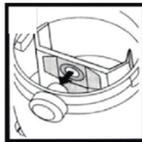
2. Coloque la manguera en el orificio del costado del tanque, gire el conector de la manguera.
